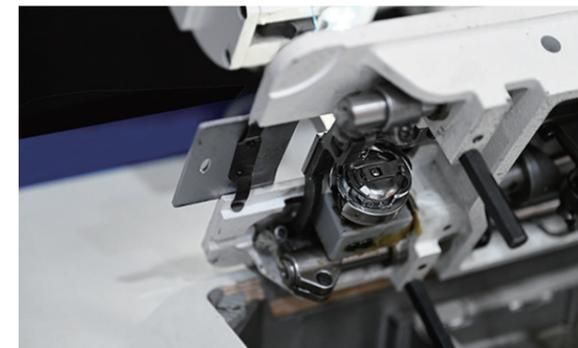
采用2倍大旋梭，缩短底线换线周期，提高缝制效率。
