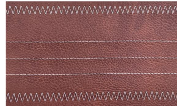
轻松切换多种缝纫方式，适用于皮革、鞋帽、箱包、厚重布料等产品的曲折缝、拼接缝、多点曲折花样缝、包边缝等
